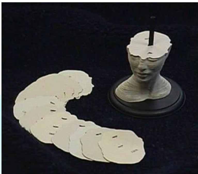
مفهوم لایه لایه شدن یک جسم سه بعدی و تبدیل آن به کانتورهای دو بعدی در این شکل دیده می شود.
